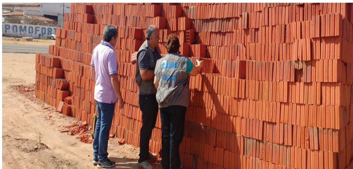
Os componentes cerâmicos devem trazer, obrigatoriamente, informações técnicas gravadas em uma de suas faces externas
